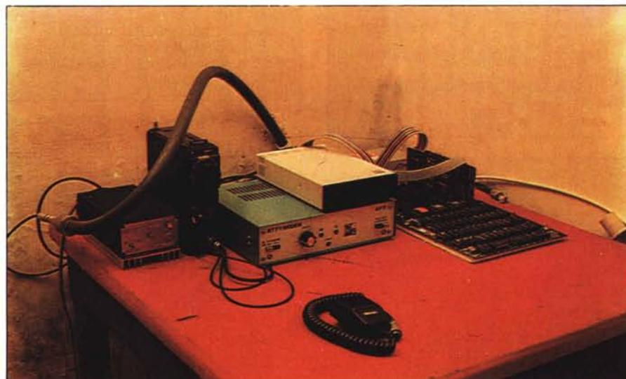
Vista dell'insieme delle apparecchiature del mailbox. Da sinistra, l'amplificatore RF, il ricetrasmittitore, il modem FSK, il floppy drive e la scheda Apple II. Si noti il cavo d'antenna che si snoda sulla stazione come un serpente, e un RG-17.
