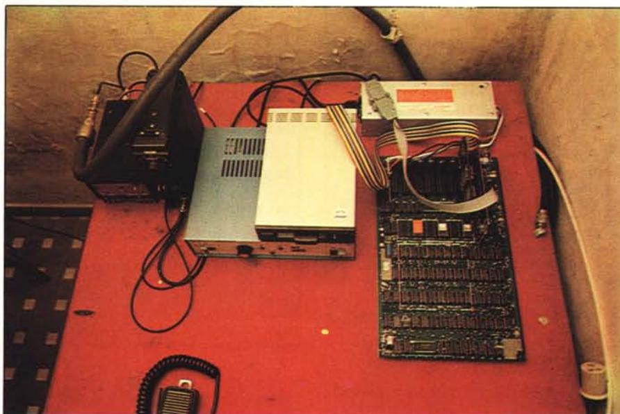
La scheda Apple non dispone di tastiera, in quanto il programma è completamente automatico. Le operazioni "service" per rimozione messaggi giacenti ed altre utility, vengono effettuate direttamente via-radio dal gestore del mailbox.
